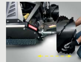
SOLLEVAMENTO PER CAMBIO RAPIDO RUOTE LIFTING FOR QUICK CHANGE OF WHEELS
