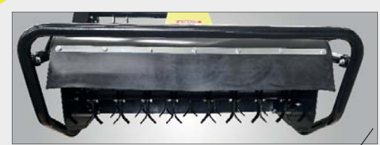
Rotore di taglio da 80 cm - 80 cm rotor of cut
